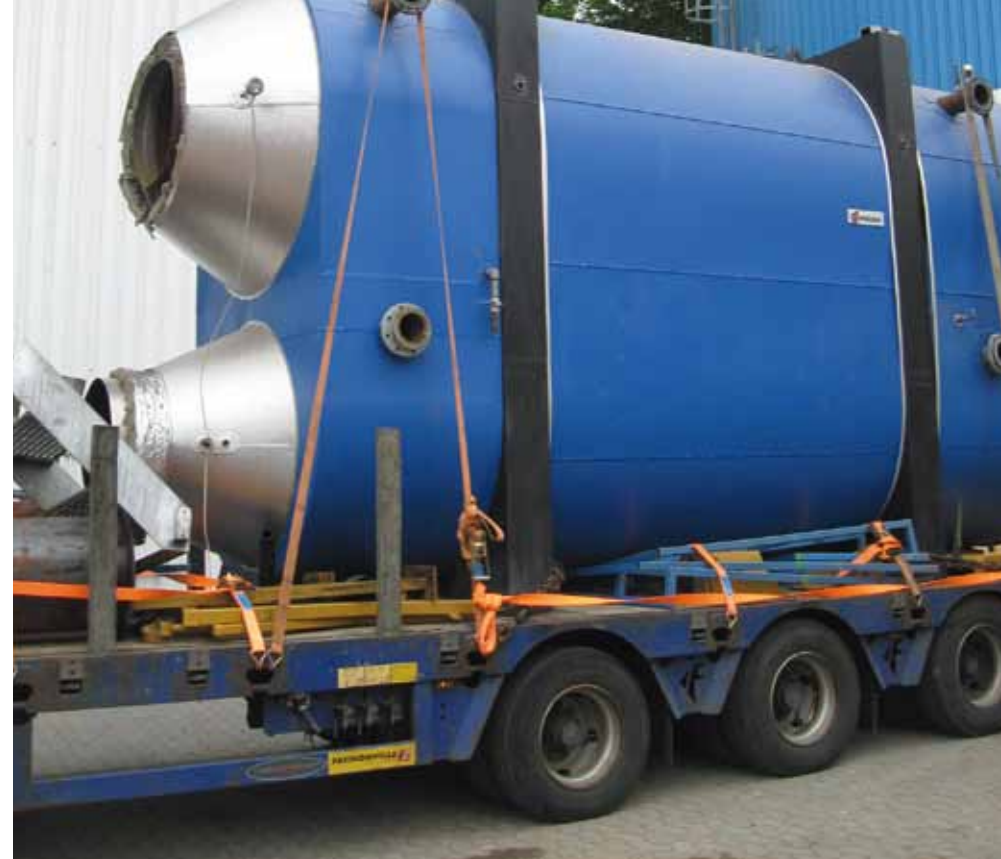
Ny røggasveksler i forbindelse med totalrenoveringen i 2012
